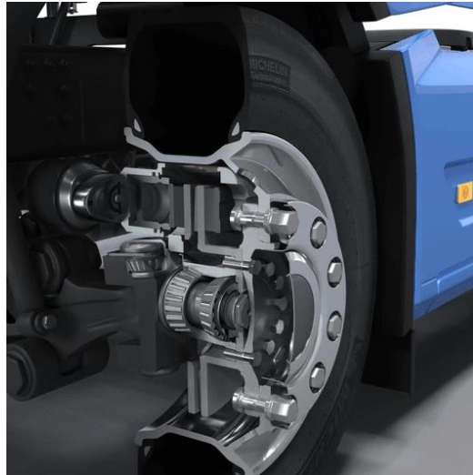
شکل ۲: استفاده از رولربیرینگ‌های مخروطی در تویی چرخ خودروها [۱].
