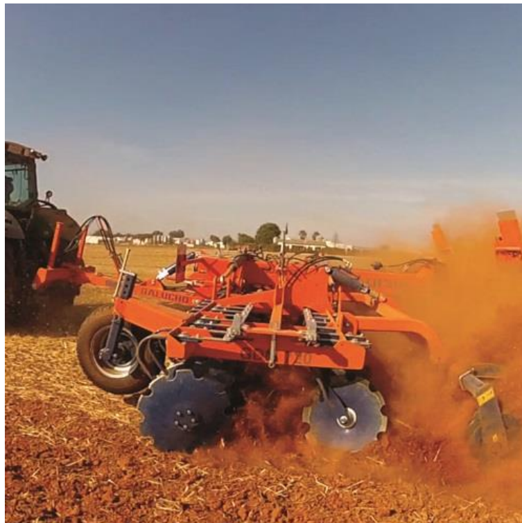
شکل ۲: آلودگی بالای محیط کاری بیرینگ‌های کشاورزی [۲].
