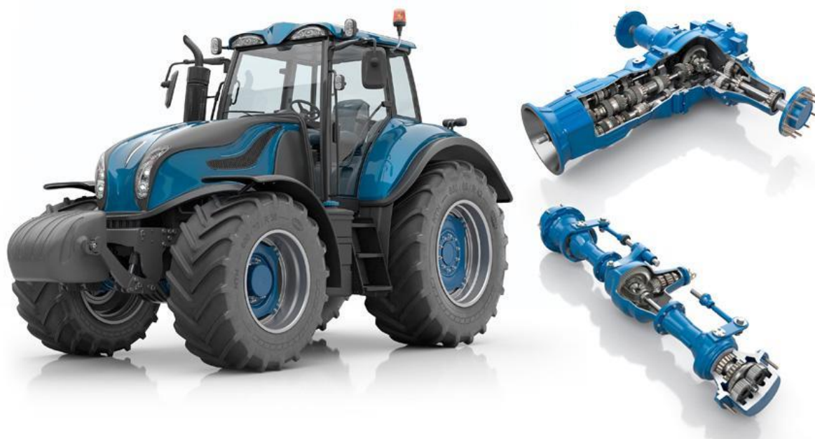
شکل ۷: برخی از بیرینگ‌های به کاررفته در یک ماشین کشاورزی [۷]
