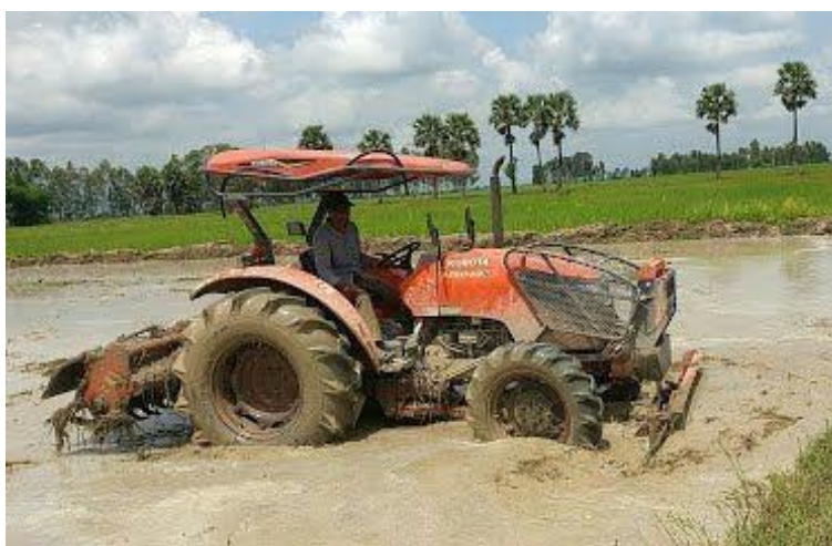
شکل ۴: استفاده از ماشین‌آلات کشاورزی در محیط‌های مرطوب، بیرینگ‌ها را با خطر زنگ‌زدگی مواجه می‌سازد.
