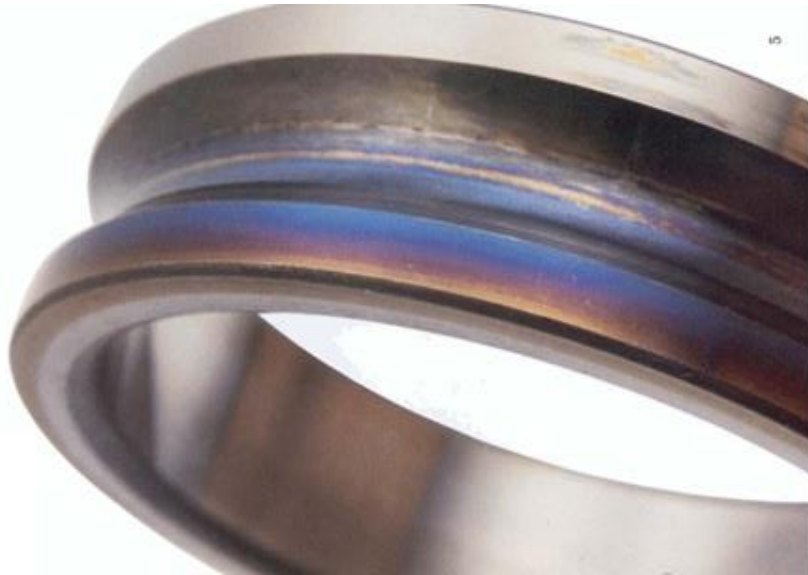
شکل ۵: یک نمونه بیرینگ غلتشی که دچار افزایش دمای بیش از حد شده است [۳].
