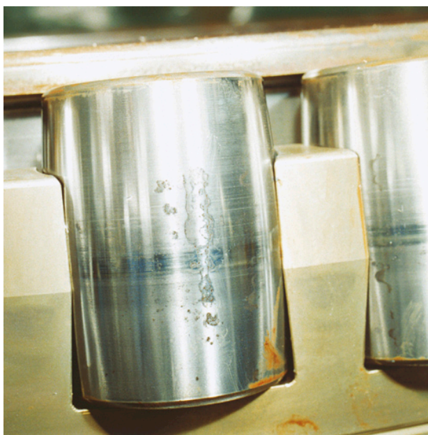
شکل ۴: المان‌های غلتشی یک رولربیرینگ کروی که در اثر میعان بخار آب به دلیل رسیدن به نقطه شبنم در هنگام انبارداری نامناسب، دچار آسیب خوردگی شده است [۴].
