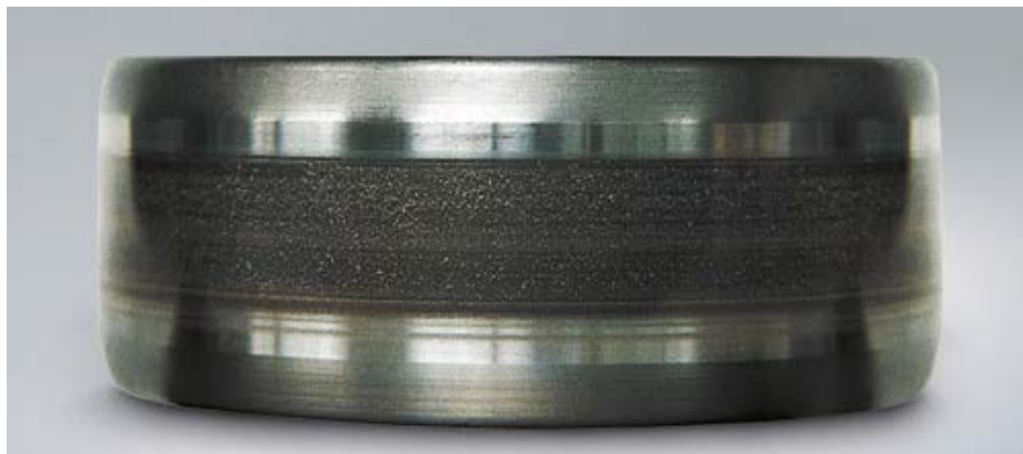
شکل ۶: رینگ داخلی یک رولربیرینگ استوانه‌ای که در اثر عبور جریان بیرینگ، دچار خوردگی شده است.
