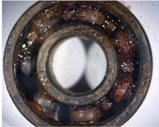
شکل ۵: یک بیرینگ غلتشی که در اثر تماس با نیتریک اسید دچار خوردگی شده است [۵].
