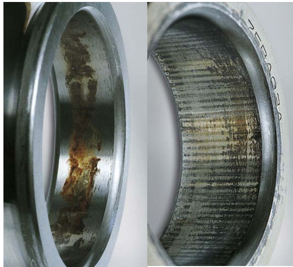
شکل ۲: یک نمونه بیرینگ با آسیب ناشی از خوردگی
