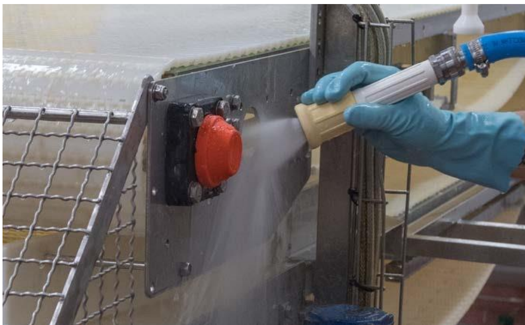
شکل ۲: شست‌وشوی خطوط تولید مواد غذایی، با خطر نفوذ آب به داخل بیرینگ و خرابی زودهنگام آن همراه است [۳].
