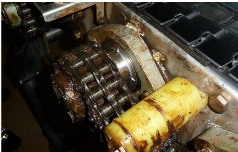
شکل ۱: تصویر یکی از درایوهای نقاله در کارخانه تولید نوشیدنی، که نشان دهنده شرایط کاری دشوار یونیت بیرینگ‌ها می‌باشد [۱].
