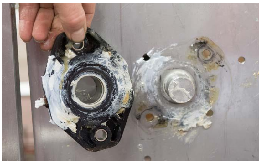
شکل ۳: باقی ماندن آلودگی در پشت یک یونیت بیرینگ، با وجود شست‌وشوی کلی خط تولید [۳].
