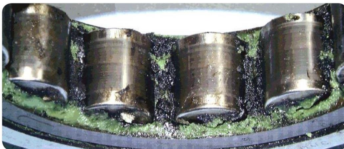
شکل ۳: تخریب روانکار درون یک بیرینگ غلتشی در اثر عبور جریان الکتریکی از آن [۴]
