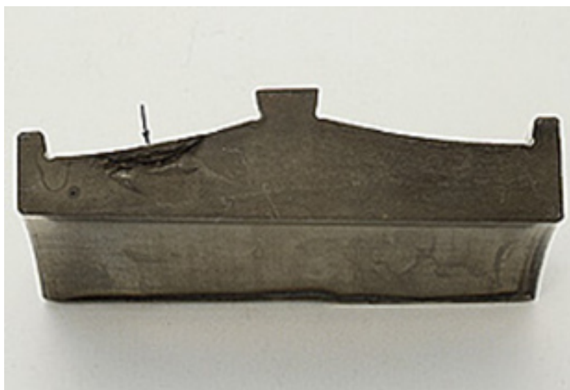
شکل ۶: جوانه زنی و رشد ترک خستگی از زیر سطح به سمت سطح بیرونی رینگ داخلی یک رولربیرینگ [۴].
