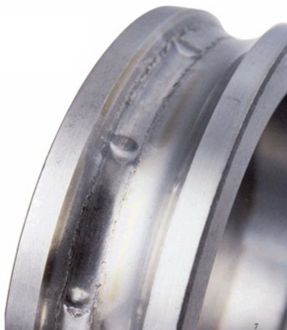
شکل ۱: دندانانهای ایجاد شده در مسیر ساچمه رو یک بیرینگ در اثر برینل شدن واقعی [۱]
