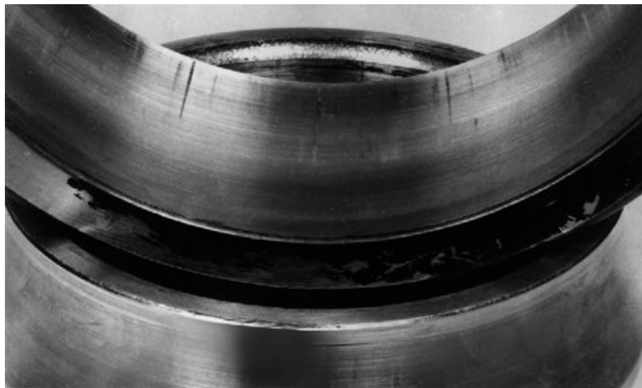
شکل ۵: رینگ یک بیرینگ غلتشی که در اثر نصب اشتباه، دچار smearing شده است [۲].
