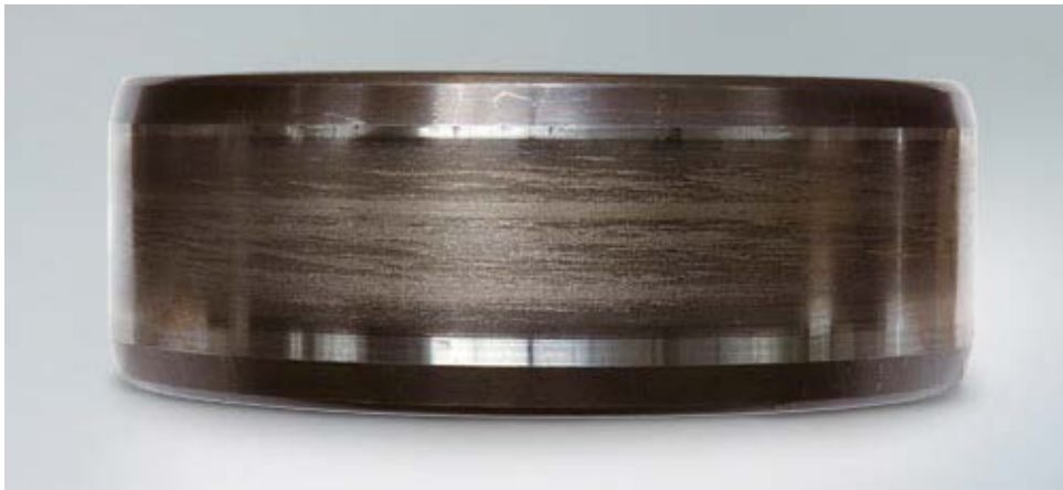
شکل ۶: رینگ داخلی یک رولربیرینگ استوانه ای که به دلیل وجود گریس اضافی، دچار پدیده smearing شده است [۴].
