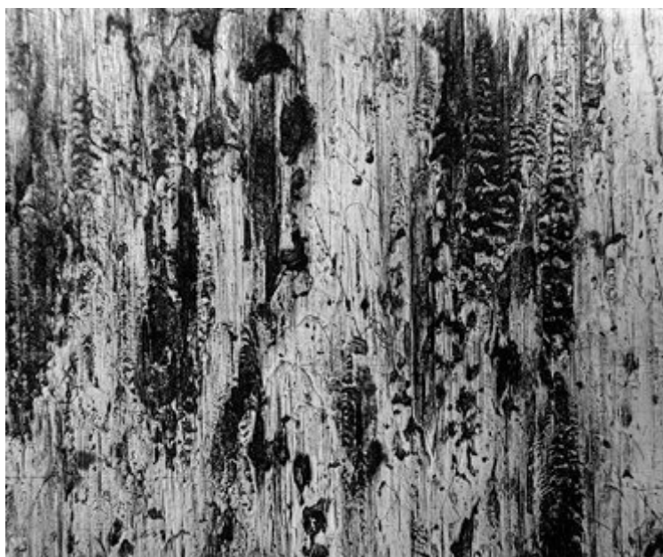
شکل ۳: سطح غلتک یک رولربیرینگ کروی که دچار smearing شده است [۲].
